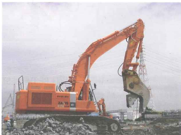
写真：ZX470に取付けたマグナム3200（左）と作業風景（右）
