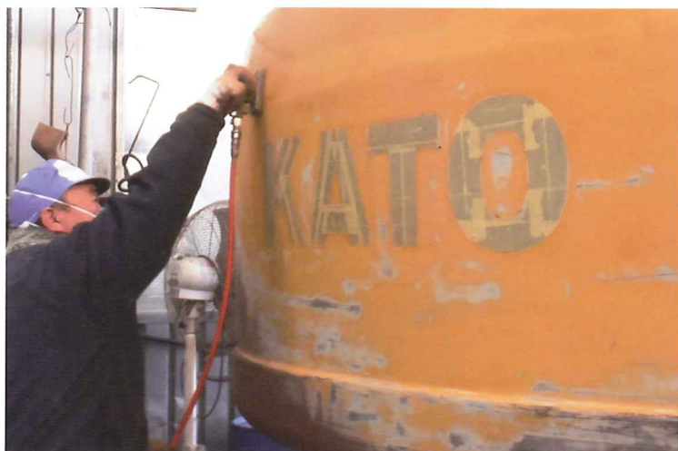
バックホウの塗装工場にて。カウンタウエイト部の傷を補修。丁寧に研磨をして仕上げをしている様子。加藤製作所の指定サービス工場として30年余りの実績がある。
