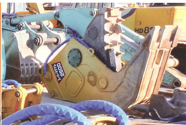
レンタル機のパクラマグナム2500。質量2500kgの1.2クラス用小割機。小割処理量が稼げるため、工期の短い大規模現場からのレンタル需要が多い。
