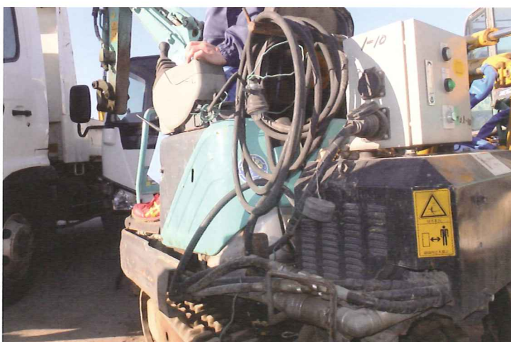
電動兼用のバックホウSK09SR。電動用の制御盤や電気コードがカウンタウエイト周辺部に搭載されている。レンタル機としてビル内装解体現場で活躍していた。
